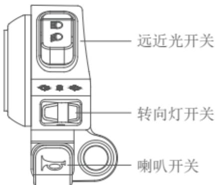
1. 转向灯开关：向左或向右推动开关手柄，可打开对应位置转向灯，发出持续闪烁的橙色灯光信号。同时，仪表盘发出绿色转向指示信号。开关手柄推到中间位置后，即可关闭转向灯。
