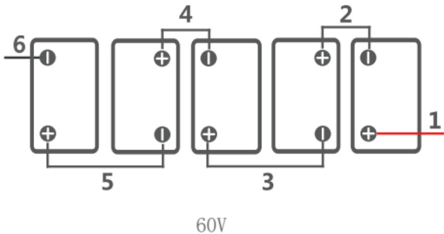
注：首先将1号线（电缆电池正极线）与单个蓄电池正极端连接，其次用电池连接线（按上图所示）将电池组串联起来，最后将6号线（电缆电池负极线）与蓄电池负极相连（仅供参考）。
