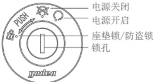
1. 电源开启：钥匙插入电门锁开关，向右顺时针旋转至 位置，接通电源，钥匙不能被拔出。
