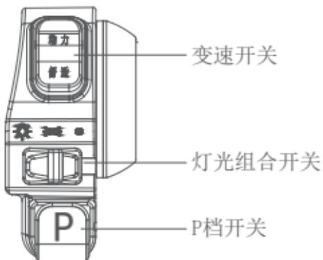
1. 灯光组合开关：在电源锁开关打开的状态下，向左、向右推动开关可以控制车辆灯光。
