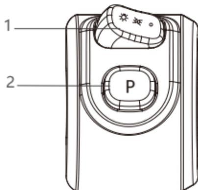
1.前灯开关：向左拨动开关即可打开前灯，向右拨动开关即可关闭前灯。
