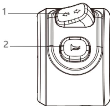
1.转向灯开关：向右拨动开关即可打开右转向，向左拨动开关即可打开左转向。
