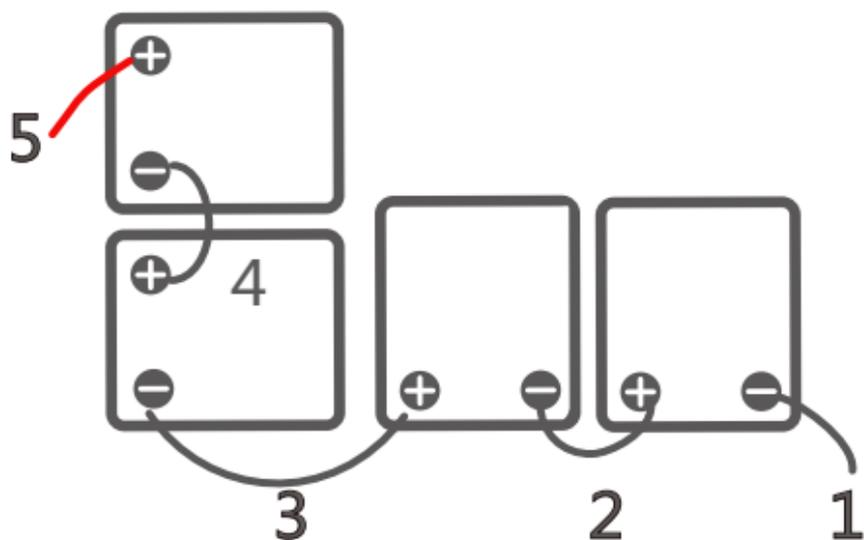
注：首先将1号线（电源线负极线）与单个蓄电池负极端连接，然后用电池连接线（按上图所示）将电池组串联起来最后将5号线（电源线正极线）与蓄电池正极相连（仅供参考）。
