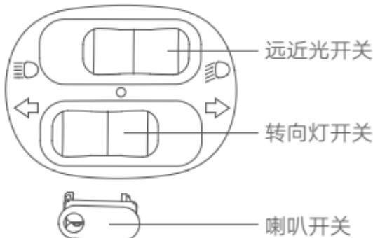
1. 远近光开关：灯光总开关打开时，向前拨动远光灯开启，向后拨动近光灯开启。
