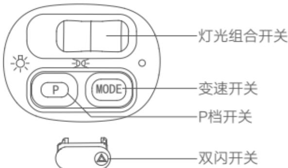
1. 灯光组合开关：在电源锁开关打开的状态下，向左、向右推动开关可以控制车辆灯光。
