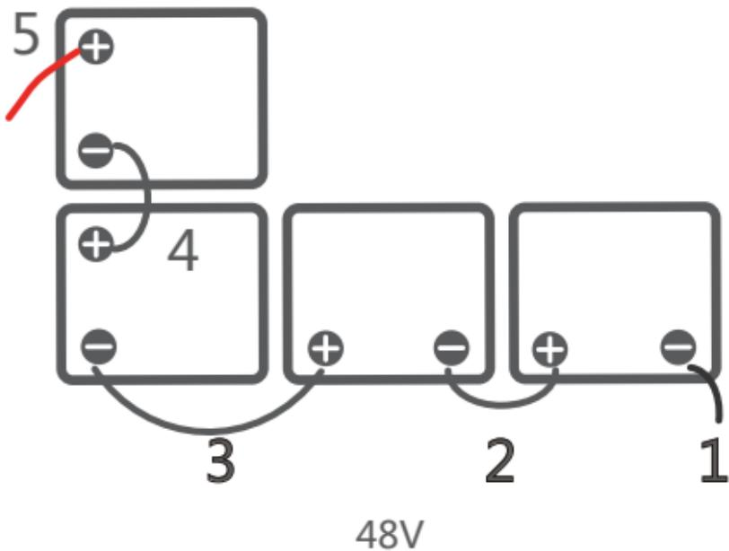
注：首先将1号线（电缆电池负极线）与单个蓄电池负极端连接，其次用电池连接线（按上图所示）将电池组串联起来，最后将5号线（电缆电池正极线）与蓄电池正极相连（仅供参考）。
